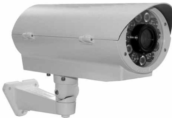
кожуха обогреватель предотвращает запотевание и обмерзание стекла при неблагоприятных погодных условиях.
