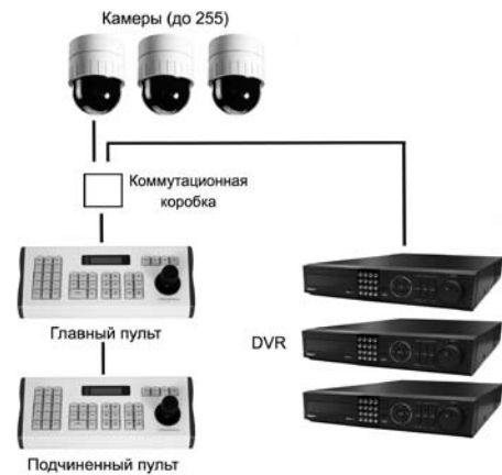
Типовая схема подключения STT-CN3R1
